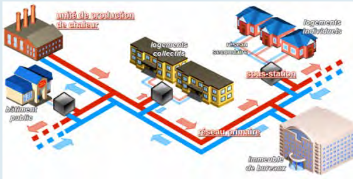
Constitution d'un réseau de chaleur (source : http://www.developpement-durable.gouv.fr/ )
