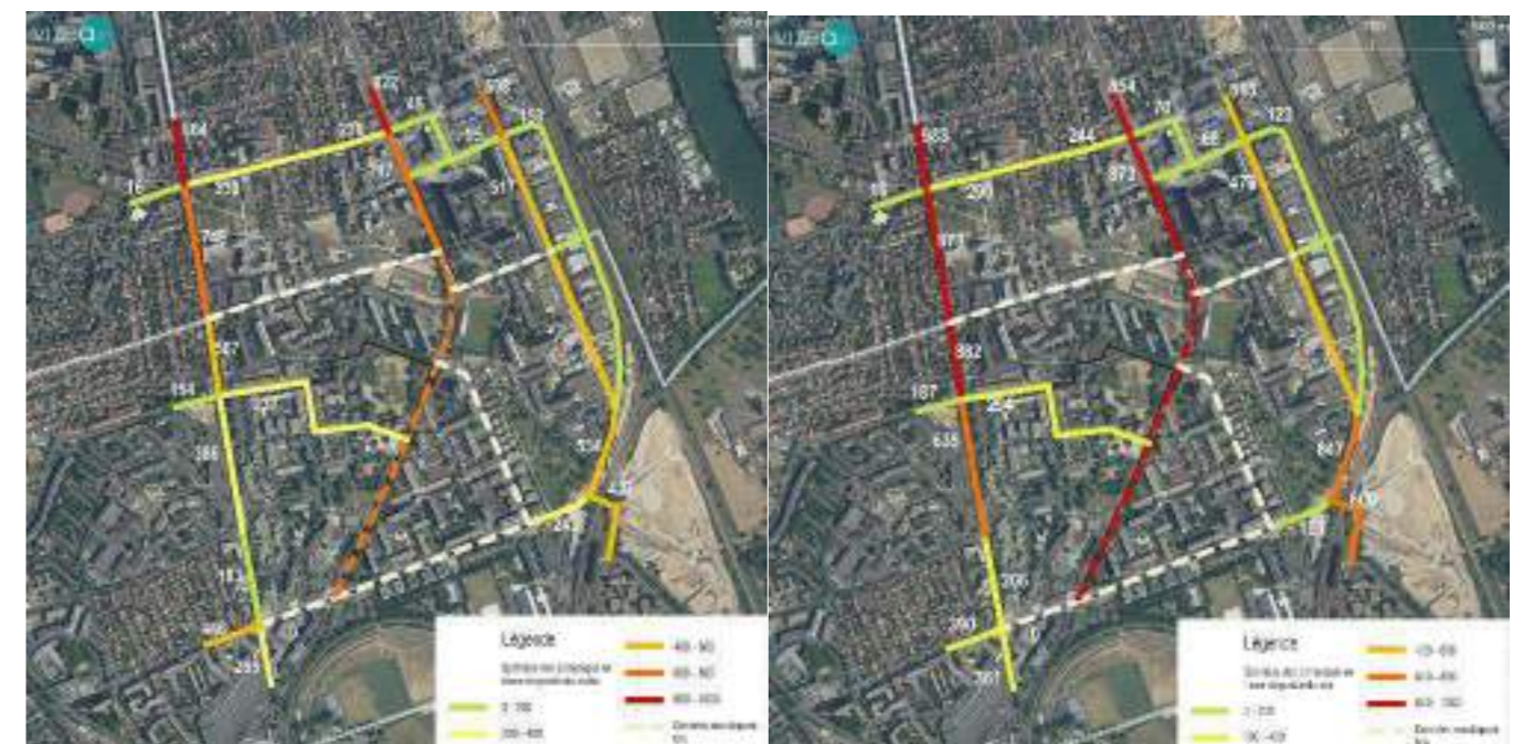
Figure 100 : Comptage du trafic en heures de pointe (matin et soir) - (Source : Etude mobilité - VIZEA, 2021)
