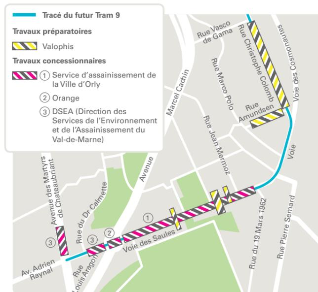
Ces travaux consistent à dévier ou à moderniser les réseaux souterrains situés sous l'emprise des futures voies du tramway : eau, gaz, électricité, télécommunications... Ce sera notamment le cas des réseaux d'assainissement gérés par la ville et l'Établissement public territorial Grand-Orly Seine Bièvre, dont les travaux débuteront dès le 4 janvier.
